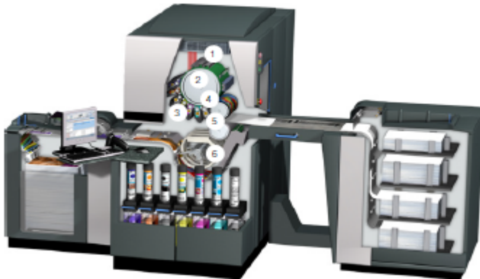
Figura 8.2 Prensa de tóner líquido (Fujifilm-Digital Print y Circular Economy)
